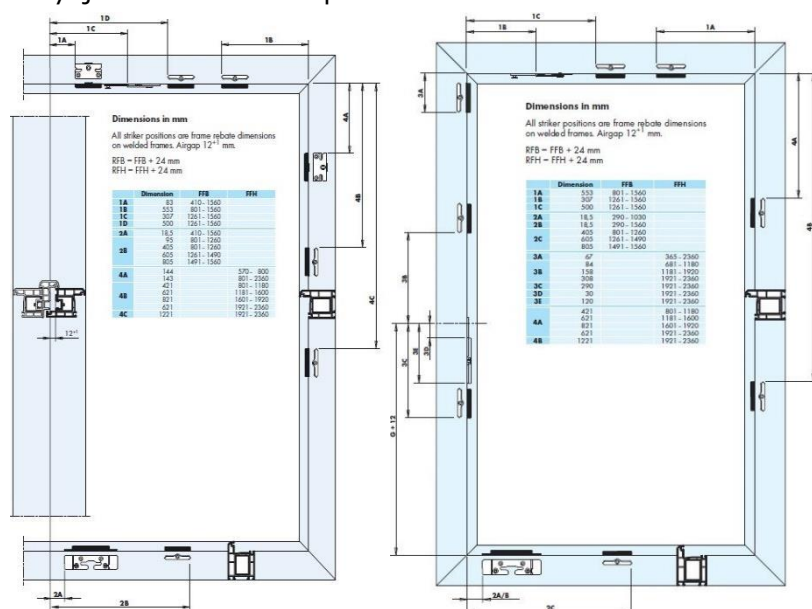
Figura 7 – Mekanizmi i mbylljes së dritareve me sistemin kërpudhë
